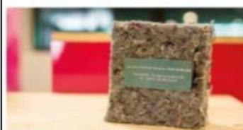
Métisse® est une gamme d'isolant thermique et acoustique pour le bâtiment, conçue à partir de coton recyclé.
